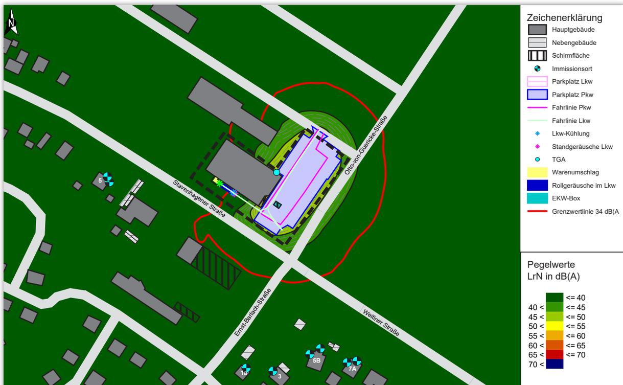
Abbildung 5-2 Beurteilungspegel gemäß TA Lärm nachts (22 - 6 Uhr) | Höhe über Gelände: 5 m
